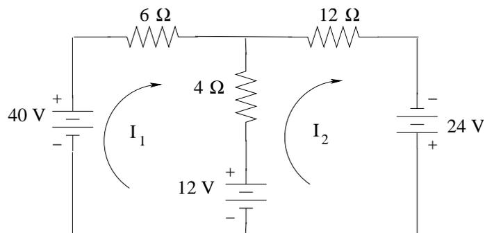
L'autoresistenza della maglia 1 è  $6+4 = 10 \Omega$ ; la resistenza mutua con la maglia 2 è di  $4 \Omega$ ; la somma delle f.e.m. di generatore nella direzione di  $I_1$  è  $40-12 = 28 \text{ V}$ . Allora l'equazione della maglia 1 è, con la legge LTK:  $10I_1 - 4I_2 = 28$ .
