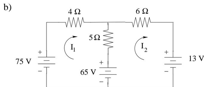
Per prima cosa convertiamo il generatore di corrente da 13 A e il resistore da 5  $\Omega$  in parallelo in un generatore di tensione, come si vede nel circuito della figura b.
