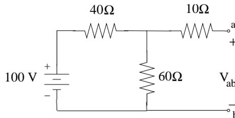
Ai capi del resistore da 10  $\Omega$  la tensione è zero: in serie a un circuito aperto, in esso il flusso di corrente è nullo. La tensione  $V_{ab}$  allora è uguale alla caduta di tensione, andando dall'alto verso il basso, ai capi del resistore da 60  $\Omega$ . Con la partizione della tensione:
