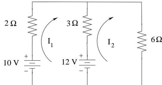
vale  $3 \Omega$ , la tensione netta collaborante di generatore vale  $10-12 = -2 \text{ V}$ . Per la maglia 2 l'autoresistenza è  $6+3 = 9 \Omega$ , la resistenza mutua è  $3 \Omega$ , la tensione netta collaborante di generatore vale  $12 \text{ V}$ . Allora le equazioni di maglia sono le seguenti:
