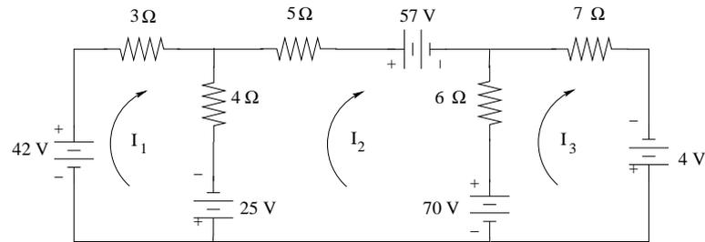
Le autoresistenze sono:  $3+4 = 7 \Omega$  per la maglia 1;  $4+5+6 = 15 \Omega$  per la 2;  $6+7 = 13 \Omega$  per la maglia tre. Le resistenze mutue sono:  $4 \Omega$  per le maglie 1 e 2;  $6 \Omega$  per la 2 e la 3,  $0 \Omega$  per la 1 e la 3. Le tensioni di generatore collaboranti sono:  $42+25 = 67 \text{ V}$  per la maglia 1;  $-25-57-70 = -152$  per la 2;  $70+4 = 74 \text{ V}$  per la maglia 3. Dunque le equazioni di maglia sono:
