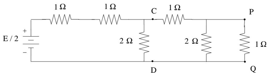
Il circuito a sinistra di CD è identico a quello a sinistra di AB, con generatore di tensione dimezzato. Quindi:  $V_{Th} = E/4$   $R_{Th} = 1\Omega$
