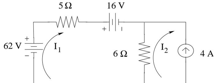
Per ricavare le equazioni di maglia è sempre meglio far uso delle autoresistenze e delle resistenze mutue. Nella maglia 1 l'autoresistenza vale  $5+6 = 11 \Omega$ ; la resistenza mutua con la maglia 2 è invece di  $6 \Omega$ . La somma delle f.e.m. di generatore nella direzione di  $I_1$  è  $62-16 = 46 \text{ V}$ . Dunque l'equazione della LTK per la maglia 1 è  $11I_1 - 6I_2 = 46$ .
