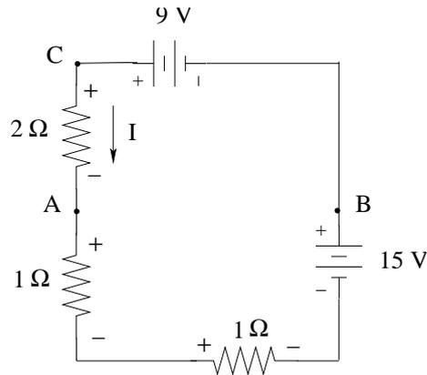
La tensione equivalente di Thevenin,  $V_{Th}$ , è la tensione  $V_A - V_B$  della figura precedente.
