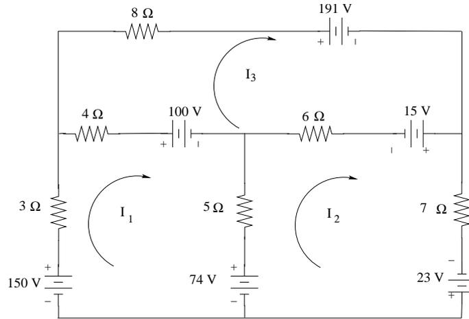
Le autoresistenze sono:  $3+4+5 = 12 \Omega$  per la maglia 1;  $5+6+7 = 18 \Omega$  per la 2;  $6+4+8 = 18 \Omega$  per la maglia tre. Le resistenze mutue valgono:  $5 \Omega$  per le maglie 1 e 2,  $6 \Omega$  per la 2 e la 3,  $4 \Omega$  per la 1 e la 3. Le tensioni di generatore collaboranti sono:  $150-100-74 = -24 \text{ V}$  per la maglia 1;  $74+15+23 = 112$  per la 2 e  $100-191-15 = -106 \text{ V}$  per la maglia 3. Le equazioni di maglia sono allora:
