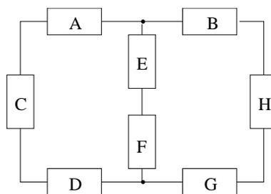
Abbiamo tre anelli: uno dei componenti A, E, F, D, C; uno dei componenti B, H, F, G, E; un terzo di A, B, H, G, D, C. I primi due sono anche maglie, il terzo non lo è perchè i componenti E, F sono al suo interno. A, C, D sono in serie in quanto percorsi dalla stessa corrente. Per la stessa ragione sono in serie anche E ed F nonchè B, H, G. Non ci sono componenti in parallelo.
